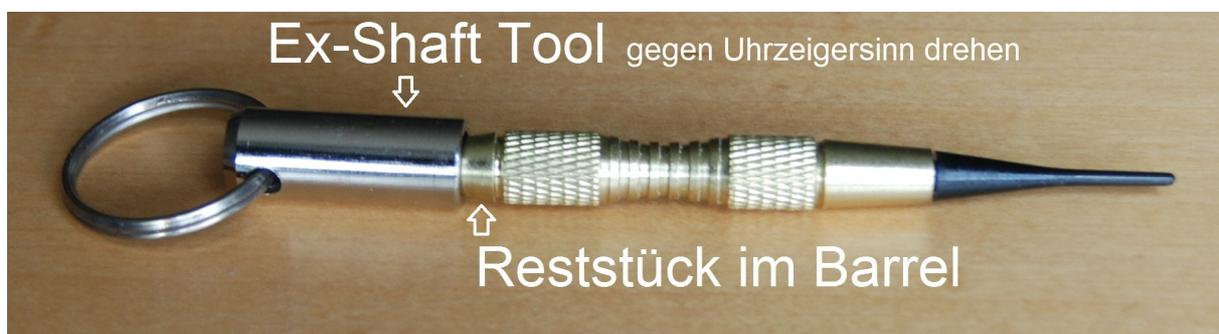
**3.) Hier ist Feuer im Spiel** - Entfernung **durch Verbindung von Kunststoff Spitze und Reststück** - Hierzu nimmt man eine Softdartspitze (Tip) schraubt diese auf einen anderen Barrel, Erhitzt diese Spitze bis diese anfängt flüssig zu werden und drückt die Spitze gegen das abgebrochene Endstück. Dann hält man es für ein paar Sekunden (ca. 30 Sekunden)
